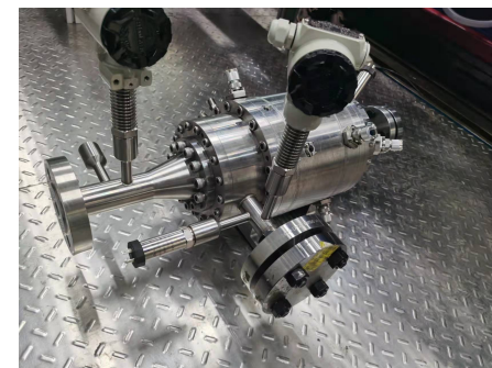
15kW级sCO 2 轴流透平(全封闭) 15kW class sCO 2 axial turbine (fully enclosed)
