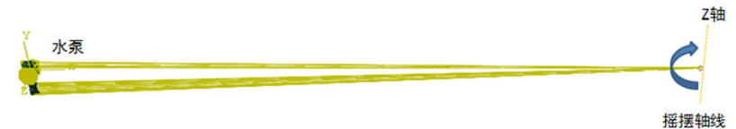
船舶横摇状态下水泵应力计算模型 Calculation model of pump stress in ship roll
