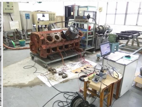
机体疲劳模拟试验现场
