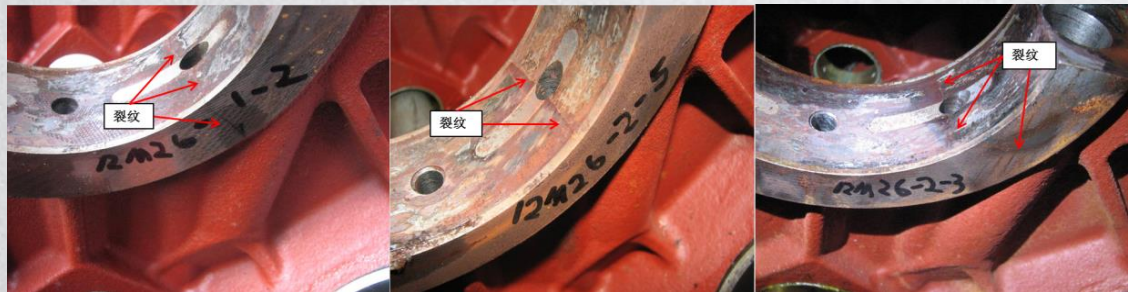
主轴承座裂纹示意图
