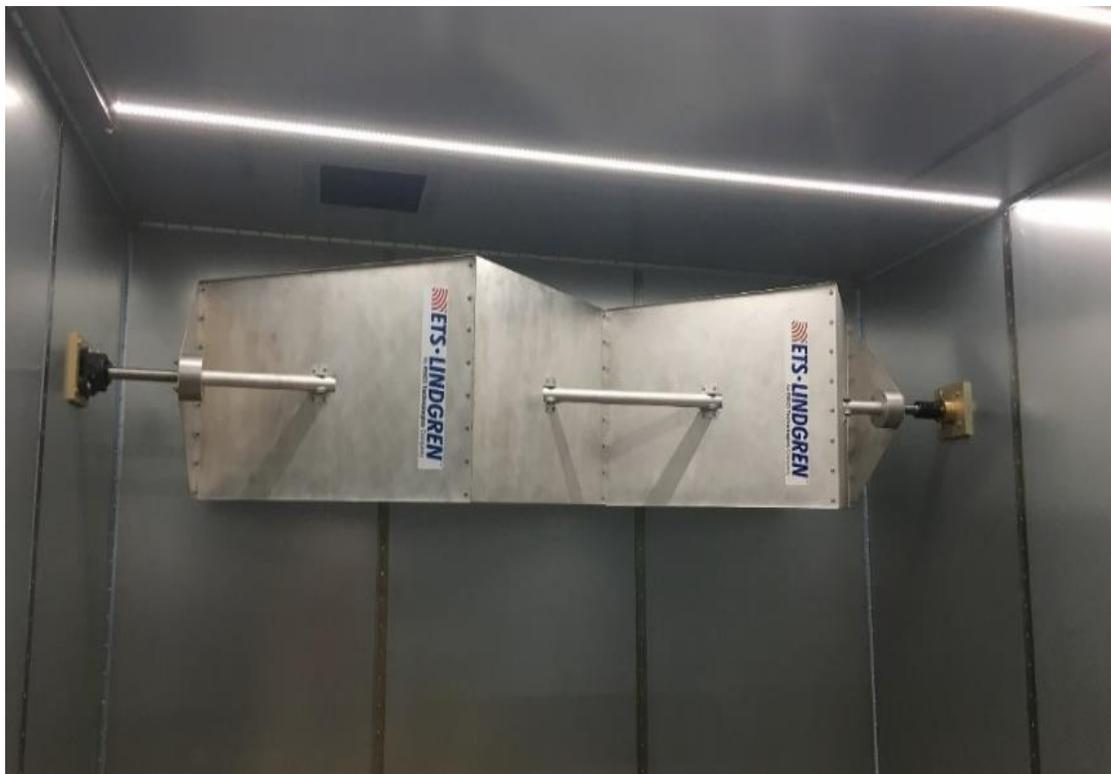
电磁混响室：产生各向同性统计均匀的连续波电磁环境
